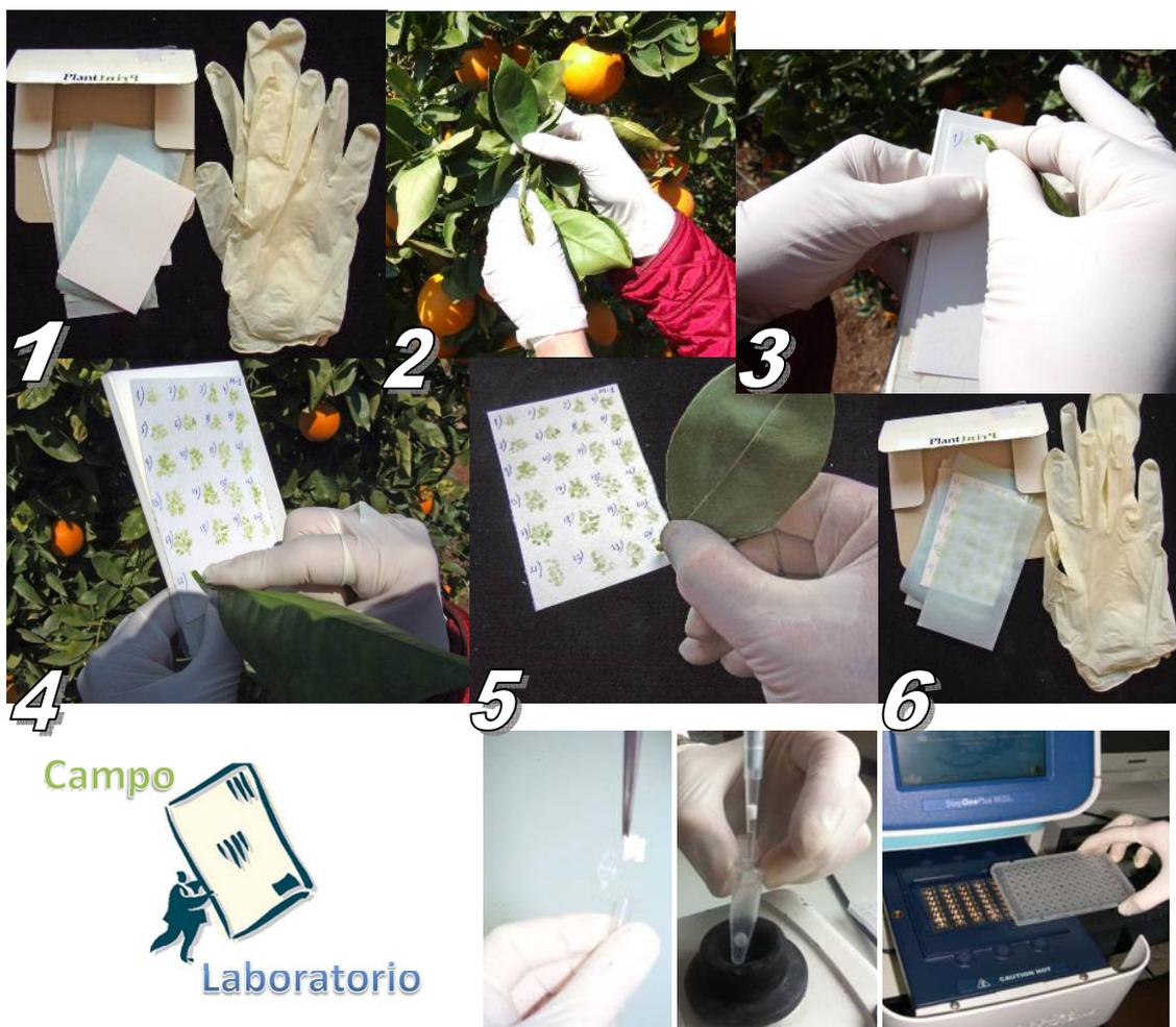
Procedimiento de impresión de savia de varias hojas sobre el mismo punto (igual georreferenciación), envío y proceso de análisis de muestras con kit de impresión:
